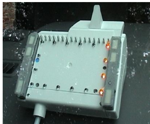
LSVA-Erfassungsgerät TRIPON â aus Sicht des Fahrzeugführers und von aussen
