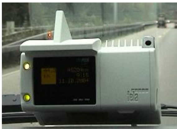
LSVA-Erfassungsgerät TRIPON â aus Sicht des Fahrzeugführers und von aussen
